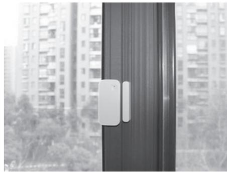
图3-5 磁控开关安装在窗户上
