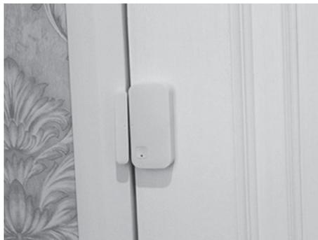
图3-4 磁控开关安装在房门上
