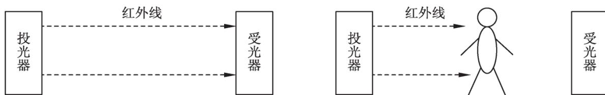
图2-8 红外对射探测器的工作原理示意图
