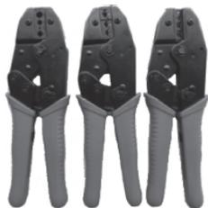
图2-42 电工快速冷压钳
