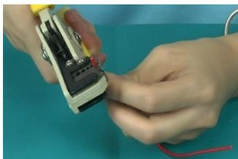
图 6-52 用剥线钳剥除护套
