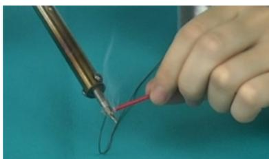
图 6-55 用电烙铁给线芯两端搪锡
