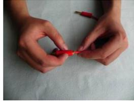
图 6-36 安装插头绝缘套
