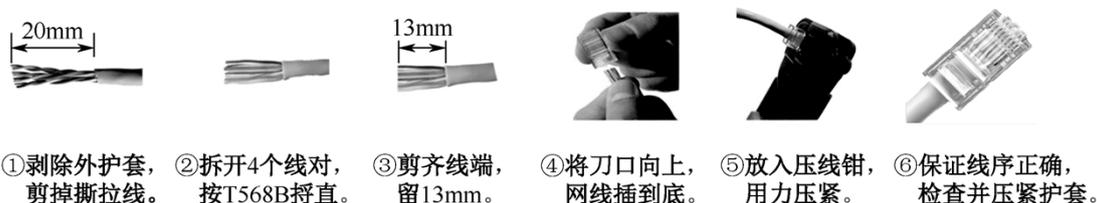
图 2-92 水晶头端接关键步骤与技能照片
