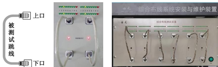
图 2-93 RJ-45-RJ-45 网络跳线测试示意图与照片
