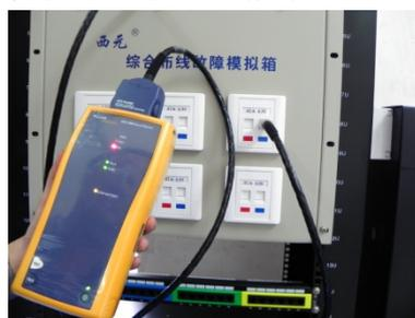
图 6-42 插入远端测试仪
