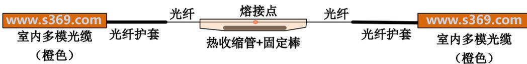
图 9-3 光纤熔接示意图
