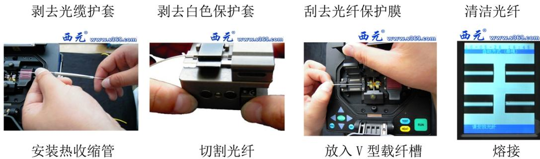
图 9-4 光纤熔接主要步骤
