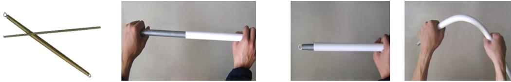
(1) 弯管器 (2) 放入弯管器 (3) 弯管器到位 (4) 弯管
