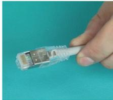
图 4-52 安装护套
