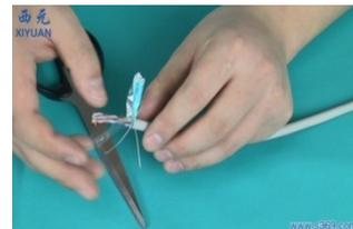
图 4-44 剪掉撕拉线、铝箔和塑料纸
