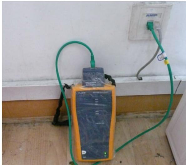
图11-33 远端端接状态
