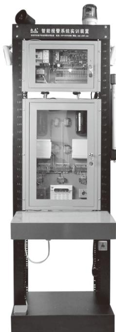
图1-20 西元智能报警系统实训装置
